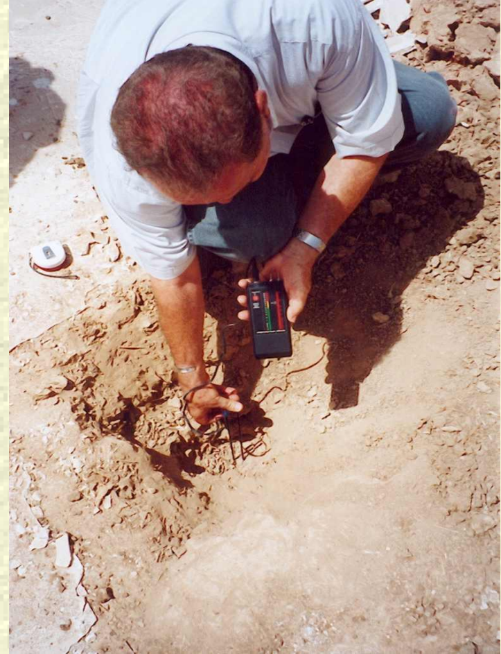
قياس الرطوبة في السطح
